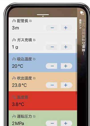
竣工直前の検査で用いる 機能検査アプリ
