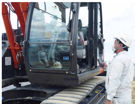
現場担当者 始業前に重機を点検しアプリで報告
